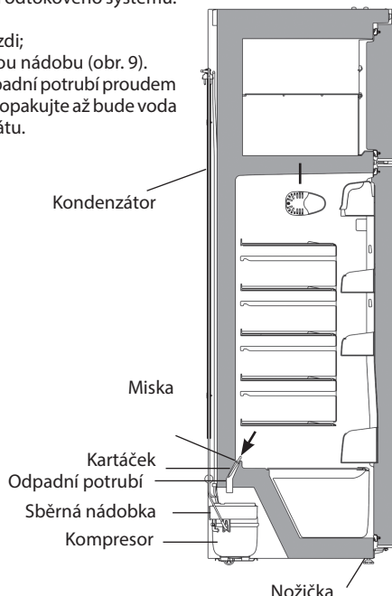
Obrázek 9 - Systém eliminace kondenzátu
