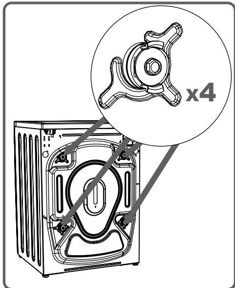
Pomocou zodpovedajúceho kľúča uvoľnite skrutky otáčaním proti smeru hodinových ručičiek
