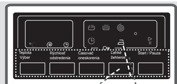
Ked' stlačíte funkciu jednoduchého žehlenia, na elektronickom displeji sa zobrazí symbol
